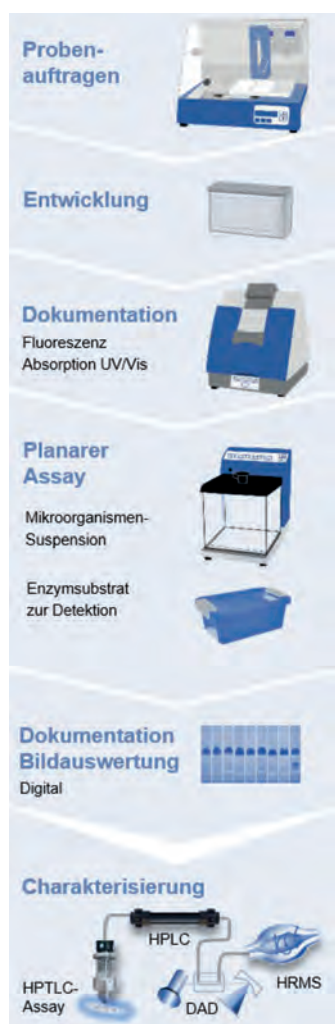
Abbildung 5: Arbeitsablauf des planaren Assay-Screenings und optionale Charakterisierung von Schadstoffzonen mit hochauflösender Massenspektrometrie
